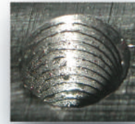
Nachdem das Sackloch gereinigt wird, kann die Bearbeitung fortgesetzt werden. Once the hole is cleared, tapping can be resumed.
